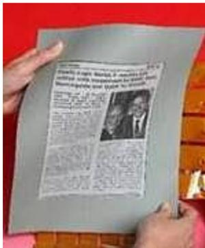
Самый большой гибкий дисплей создала компания Plastic Logic. Он изготовлен на основе органической активной матрицы, его толщина при покрытии пленкой от E Ink составляет менее 0,4 мм. 10-дюймовый экземпляр характеризуется разрешением 600x800 точек и отображает четыре оттенка серого. Подложка экрана создана с использованием низкотемпературной технологии. Общественности новинка будет продемонстрирована на 12-й международной выставке
