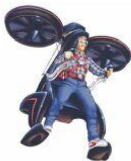
С диапазоном 200 км и скоростью полёта 70 узлов, Соло Трек имеет возможность оставаться в воздушном пространстве до двух часов непрерывного полёта и подниматься до 8 км. Аппарат очень мал, и пилот может приземляться на любую поверхность очень маленького размера. НАСА успешно провела испытание опытного образца в 2000 году.
