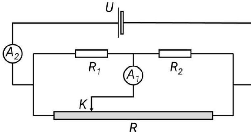
Полное сопротивление не включённого в схему реостата, измеренное между его крайними точками, равно  $R = 1$  кОм.
